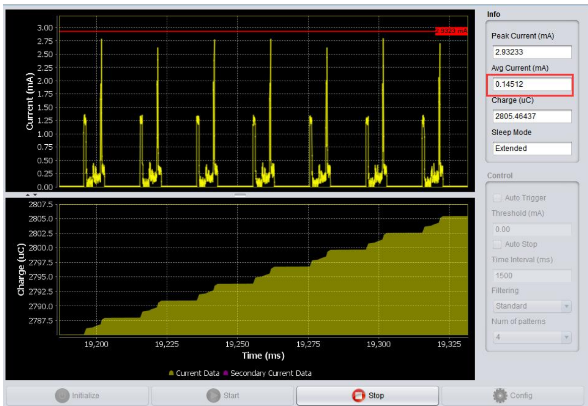
图四：睡眠状态-已连接电流
